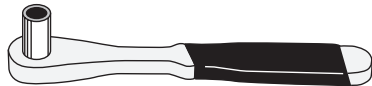
3/4", 1/2" Socket on Ratchet Trinquete con casquillo de 3/4, 1/2 pulg. Douille de 3/4, 1/2 sur cliquet
